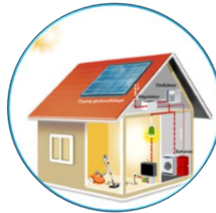
Installation photovoltaïque pour site isolé
