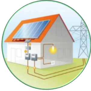
Installation photovoltaïque raccordée au réseau de la STEG
